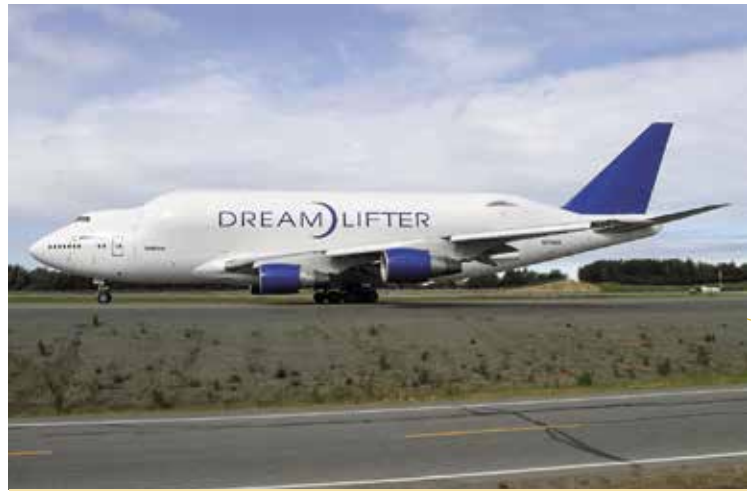
BOEING DREAMLIFTER: Die besondere Frachtversion der B747 wird genutzt, um Baugruppen für die Boeing 787 aufnehmen zu können, die weltweit produziert und zur Endmontage nach Seattle Everett geflogen werden. Zum Be- und Entladen wird das Heck zur Seite geschwenkt. Photo: Michael Stappen
